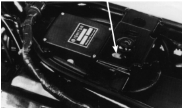
CONECTOR DOS FIOS DO GERADOR DE PULSOS
